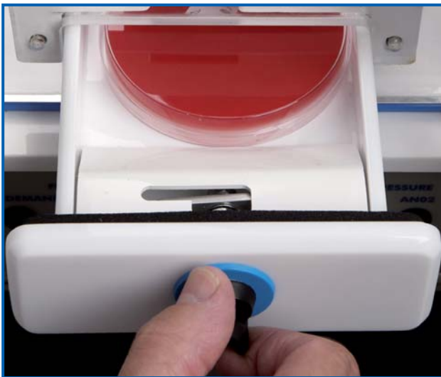
Optionaler 9cm Einplatteneinschub – für das schnelle Einbringen von einzelnen Proben
